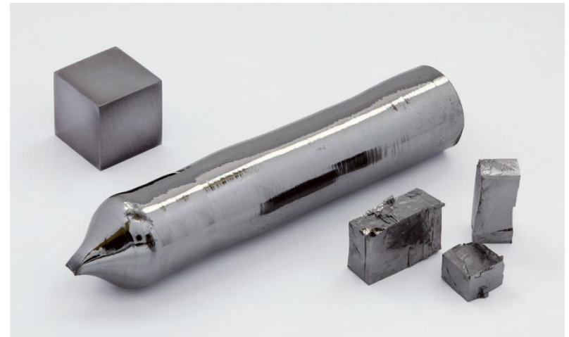
Ta-Einkristall und Bruchstücke – Quelle: www.pse-mendeleejew.de
